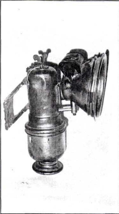
*Foto 4: Lámpara de carburo para bicicleta marca «Excelsior» (?). Se enganchaba al manillar o al carenado de la rueda delantera. Fue utilizado en Bélgica. Se desconoce el año de fabricación.*
